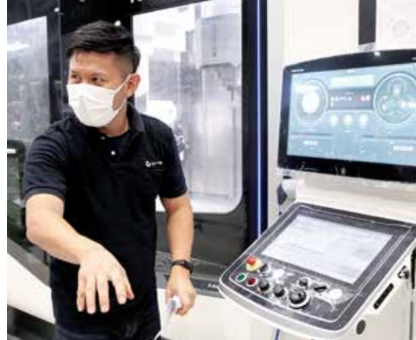
写真左は、工場内の工作機械の稼働状況のモニタリング画面。手動による記録や集計の手間がなくなり、正確な稼働状況が一目ですぐ分かる。また、これまで工作機械に直接入力していたプログラミング（写真右）を遠隔入力できるようにし、リモートワークも可能にした
